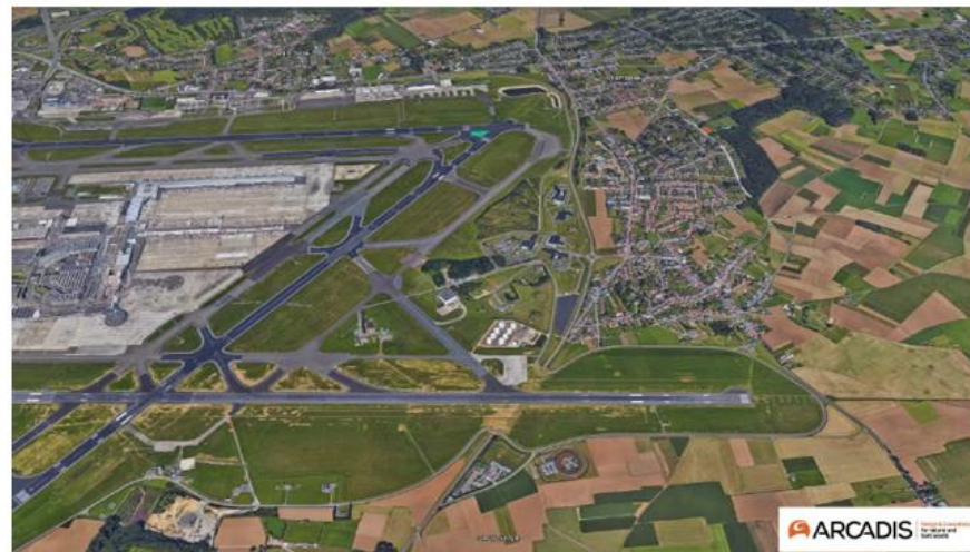
Optie B – variant 1: verlenging baan 25L zonder geluidswerende buffer
